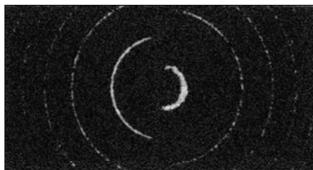
Рис. 2. Спектрограммы возбуждающего (слева) и рассеянного (справа) излучения. Область дисперсии эталона Фабри–Перо 3,33 \cdot 10^{-2} \text{ см}^{-1}
